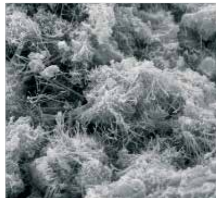
Kryštály vyplňujúce póry (cca. 5000-násobné zväčšenie)
