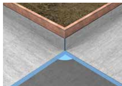
3b. Zahnutie hrán na fólii AQUAFIN-WM12 a vytvorenie zvaraného spoja alebo lepeného spoja pomocou AQUAFIN-CA.
