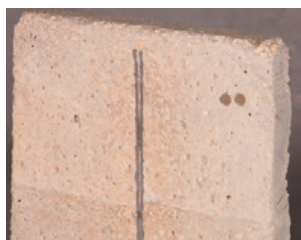
Divu AQUAFIN-CJ5 lokšņu savienojums betonā, šķērsgriezumā.
