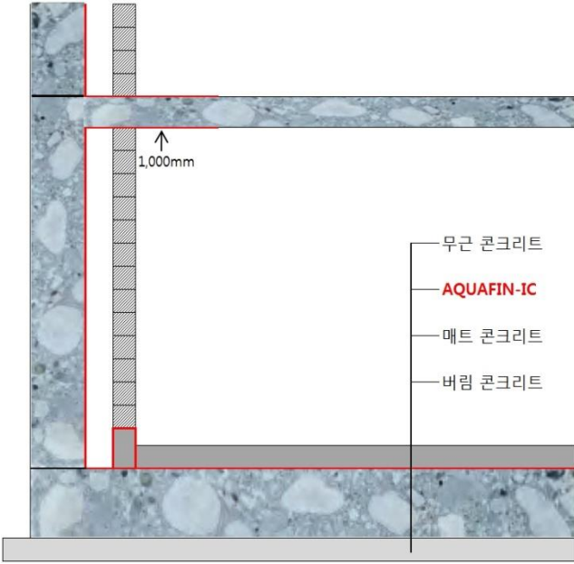
지하 구조물 등의 바닥, 벽체, 천정
