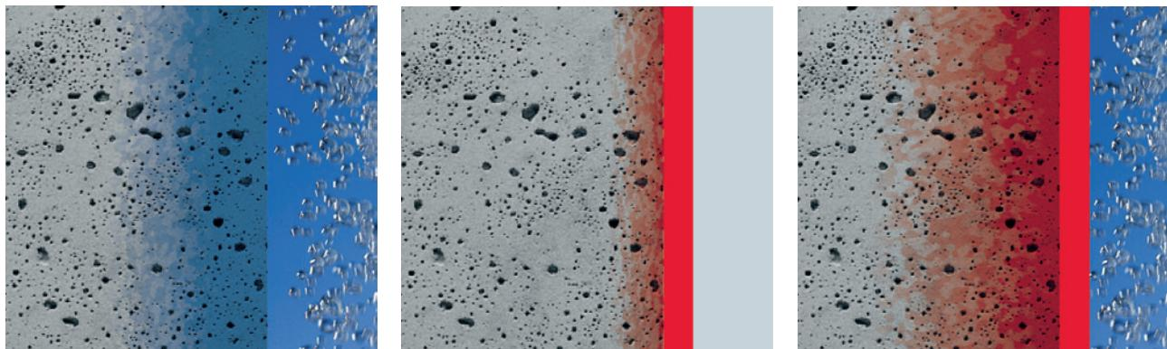
Nepremazan beton je porozan sustav podložan prodiranju vode.
