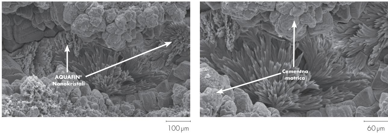
Povećani AQUAFIN-IC nanokristali. Premazan beton postaje vodonepropustan kada kristalna vlakna popune kapilarne šupljine.
