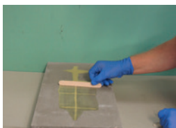
Снять лишний материал
