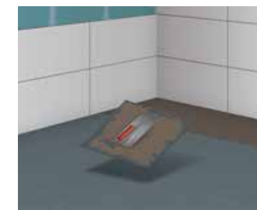
11 Application d'une couche de contact pour un revêtement grand format
