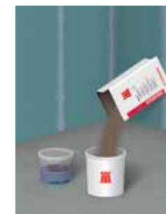
3 La poudre est versée dans le seau de gâchage
