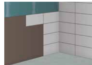
7 Pose de la céramique au mur
