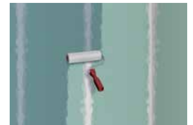
2 Application du primaire sur le support, p. ex. ASO®-Unigrund
