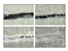
Cicatrisation des fissures Au contact du béton adjuvanté de BETOCRETE avec l'eau, l'agent actif forme une solution qui réagit avec le CO2 et l'hydroxyde de calcium du béton, formant alors des cristaux en mesure de colmater des fissures jusqu'à 0,4 mm.
