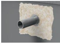
5. Sable de quartz Après durcissement, appliquer la 2ème couche de Primaire ASODUR-SG3-thix au rouleau puis saupoudrer le produit frais de sable de quartz de grain 0,5 - 1 mm.
