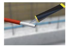
de décompression Appliquer la colle PVC fournie à saturation sur l'extrémité du raccord du flexible.
