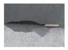
1. Egalisation des éclats Réparation des petites fissures et défauts à la truelle ou à la lisseuse. Application du Mortier de réparation ASOCRET-BIS-5/40 "frais sur frais" sur le Badigeon d'accrochage ASOCRET-KS/HB.
