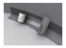
des jonctions sol / mur Au niveau de la jonction sol / murs, et sur les joints de raccordement, appliquer l'Etanchéité AQUAFIN-2K/M-PLUS au pinceau ou à la lisseuse puis coller la Bande d'étanchéité ASO-Dichtband-2000-S, sans pli ni inclusion d'air. La bande sera intégralement recouverte lors de l'application de l'étanchéité de surface.
