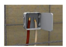
7. Raccordement de différents tronçons de gaines Amener les extrémités des gaines de
