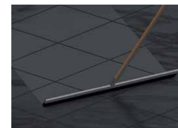
6 Retrait de l'excédent de mortier par un racle en diagonale
