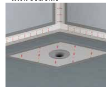
7 Collage de la Platine d'étanchéité Sol ASO®-Dichtmanschette-Boden dans la 1 ère couche d'étanchéité
