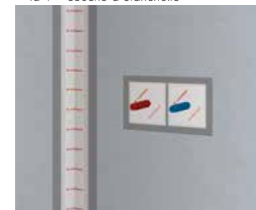
6 Collage de la Platine d'étanchéité Mur ASO®-Dichtmanschette-Wand dans la 1 ère couche d'étanchéité
