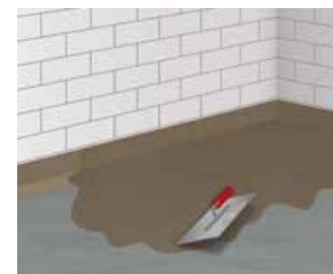
7 Application de la 1 ère couche d'étanchéité
