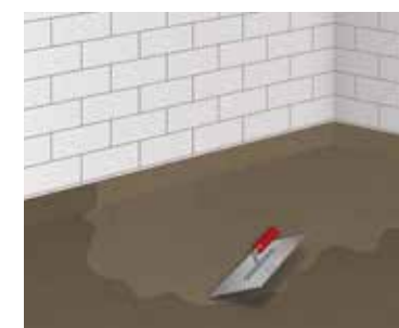
9 Application de la 2 ème couche d'étanchéité
