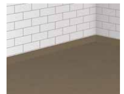
10 Etanchéité achevée, prête pour la pose de carreaux !
