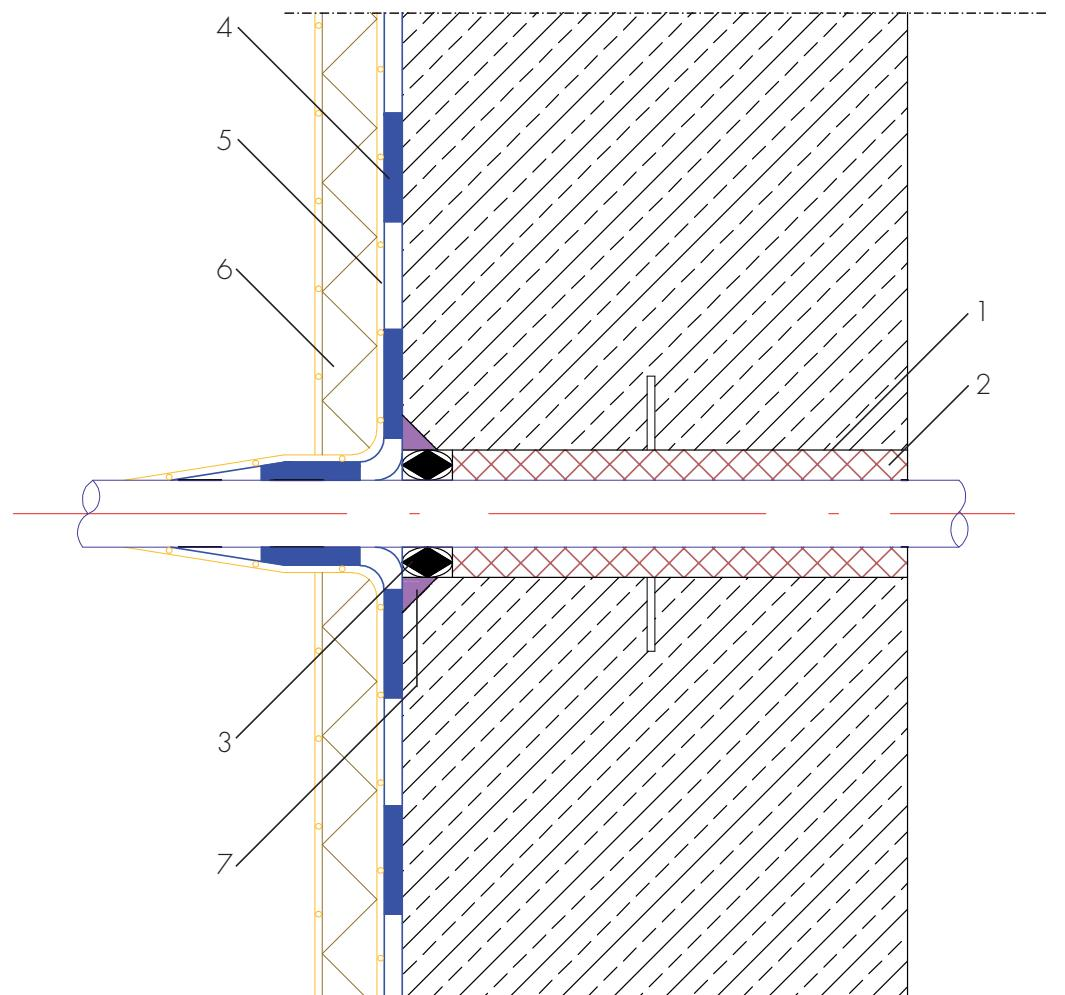
1. Gaine de tuyau (selon les directives pour la planification et la réalisation des étanchéités d'éléments de construction en contact avec la terre avec des badigeons flexibles)
