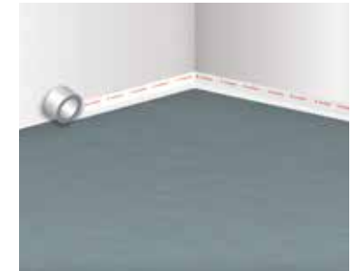
4 Placing the edge isolating strip RD-SK50
