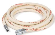
Um einen zu hohen Mörteldruck in der G4 zu vermeiden, müssen von der Maschine weg Mörtelschläuche mit einem Durchmesser von 35 mm genutzt werden.
