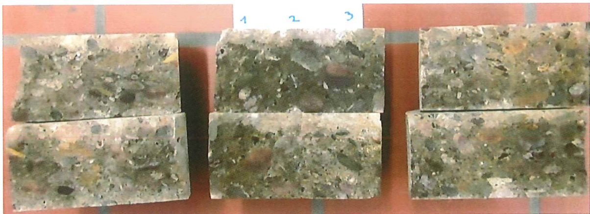
Anhang A4-4: Proben nach der Prüfung, CP 360-WP
