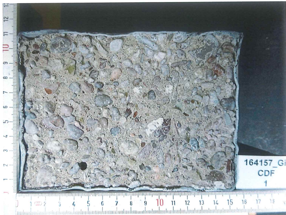
Anhang A3-6: Probekörper nach der Prüfung, Referenz
