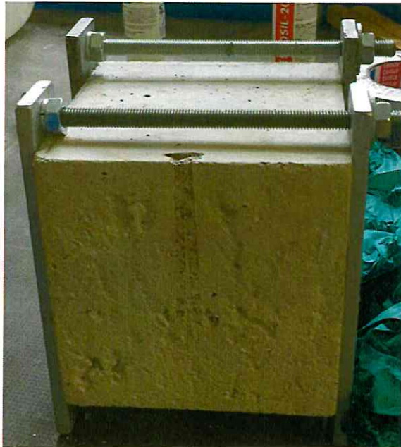
Anhang A-1: Probekörper vor der Risseinleitung
