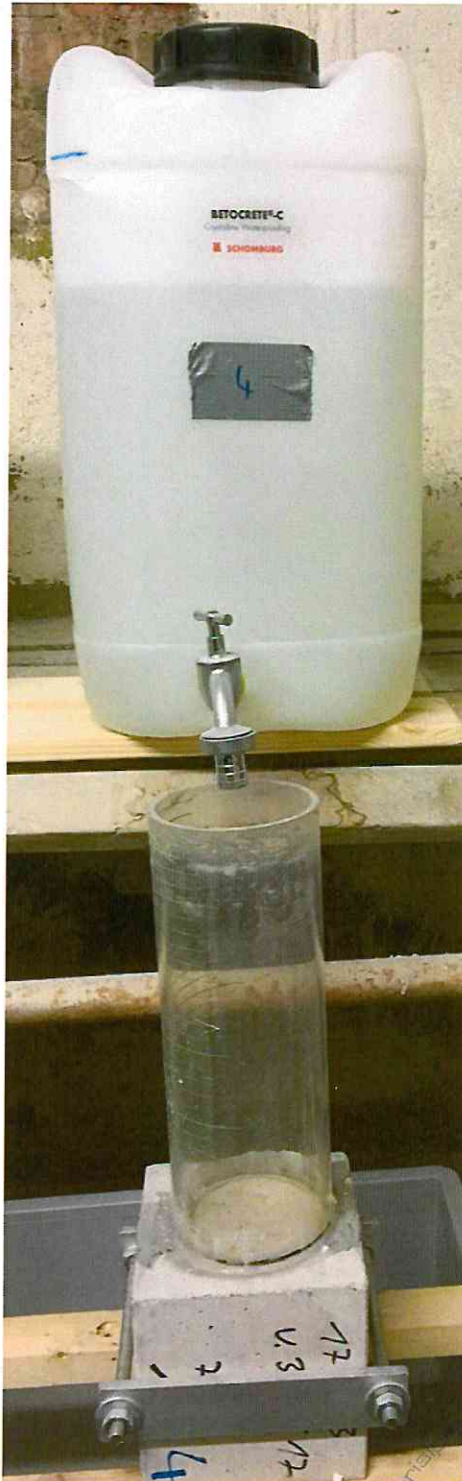
Anhang A-3: Prüfaufbau zur Prüfung des Wasserdurchflusses
