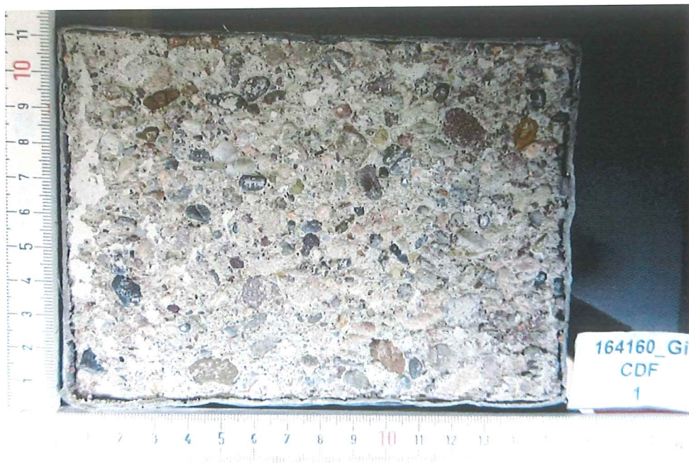
Anhang A1-12: Probekörper nach der Prüfung, CL 210-WP
