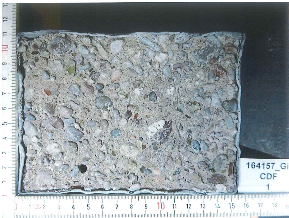
Anhang A3-6: Probekörper nach der Prüfung, Referenz
