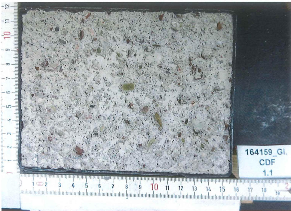
Anhang A3-18: Probekörper nach der Prüfung, CL 170-P mit LP
