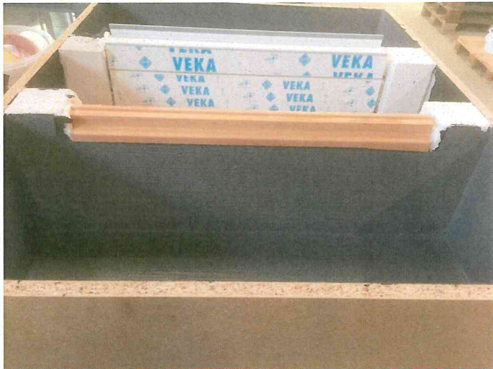
Bild A10: 1. Beschichtung mit AQUAFIN-RB400
