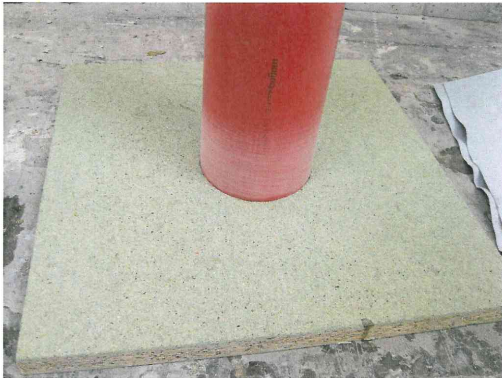
Bild A1: Probekörper für den Dichtigkeitstest einer Rohrdurchführung
