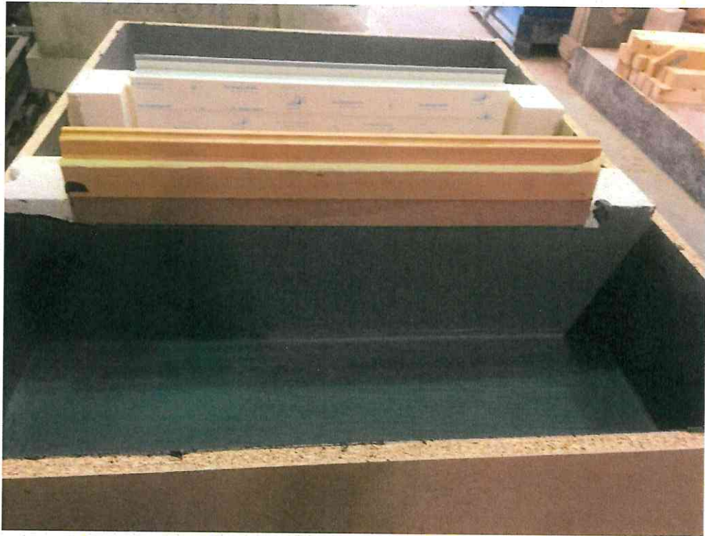
Bild A7: fertige Beschichtung nach dem 2. Auftrag AQUAFIN-RB400
