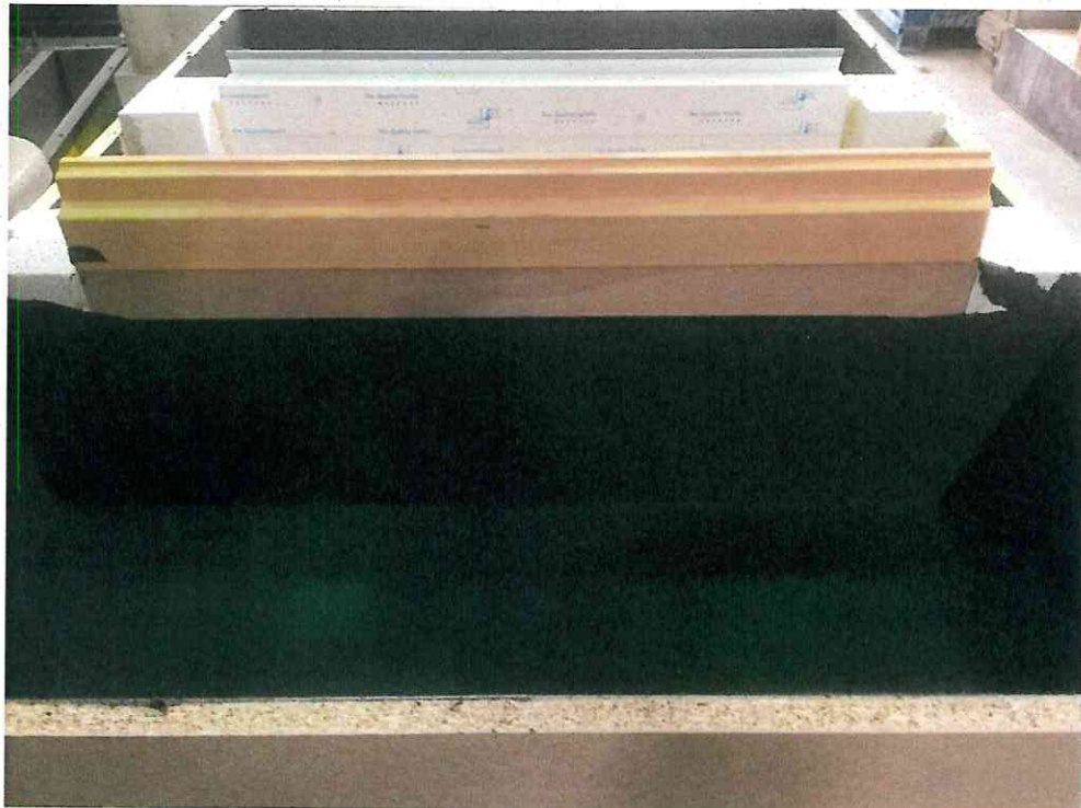
Bild A6: 1. Beschichtung mit AQUAFIN-RB400
