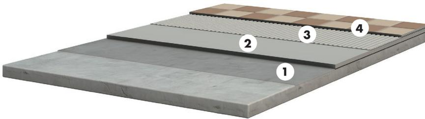
Führen Sie zunächst eine Feuchtigkeitsprüfung durch. Der CM-Feuchtigkeitsgehalt darf bei Estrich auf Dämmung oder Trennlage 2,0 CM % nicht übersteigen. Heizestriche müssen vorab aufgeheizt werden. Bei CT-Estrichen im Verbund entfällt eine Feuchtigkeitsmessung.
