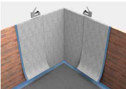
4. Bahnüberlappungen miteinander verschweißen oder verkleben.
