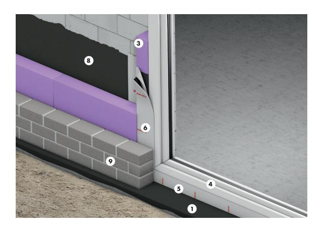
Die Abdichtung von bodentiefen Elementen in der zweischaligen Wandkonstruktion ist eine besondere Herausforderung für Planer und ausführende Gewerke. Erschwerend kommt hinzu, dass die Abdichtung gewerkeübergreifend erfolgt. Durch das AQUAFIN Dichtsystem, bestehend aus verschiedenen hochelastischen Dichtbändern in Kombination mit der flexiblen mineralischen Abdichtung AQUAFIN-RB400, wird das Detail im Kontext von Materialwechseln sicher abgedichtet.
