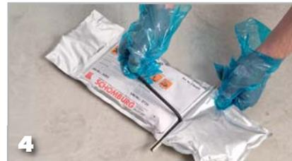
**4** Entfernen Sie nun die schwarze Rundschnur an der Knetbeuteloberseite und kneten Sie den Beutel gleichmäßig ca. 3 Minuten lang. Der Beutel wird währenddessen warm.
