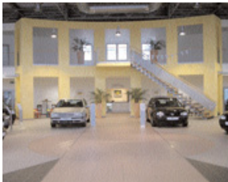
Autohaus Stengelmann in Detmold 1200 m 2 Anhydritfließestrich wurden bei 1,5 % Restfeuchte mit Fliesen belegt. Ohne UNIFIX®-AEK war der knappe Zeitplan nicht zu halten.
