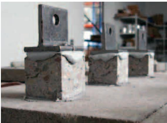
Bis mindestens zu einer Betongüte von C20/25 verläuft der Bruch bei der Haftzugprüfung im Beton. Die gemessenen Haftzugwerte liegen im Rahmen der Messgenauigkeit für beide Produkte bei ca. 3 N/mm<sup>2</sup>.
