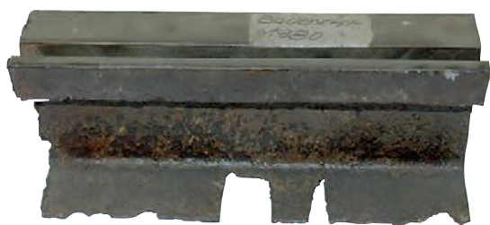
Streustromschäden an Rillenschienen
