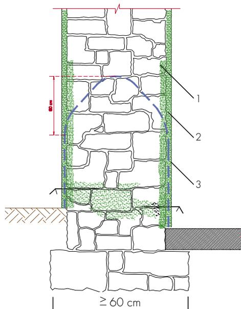
Sanierung bis mindestens 80 cm über Feuchtigkeitsanfall bzw. erkennbaren Salzbefall durchführen.
