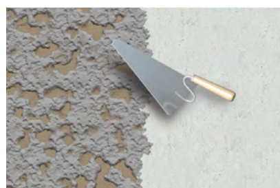
1. Nanesení jádrové omítky (v případě potřeby)
