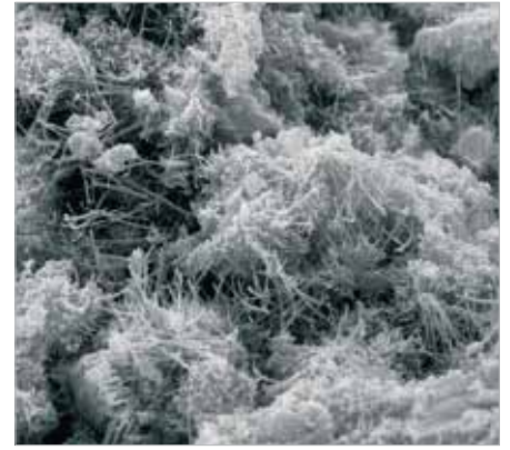
krystaly vyplňují póry v betonu (cca 5000násobné zvětšení)
