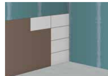
7 Verlegen der Wandkeramik
